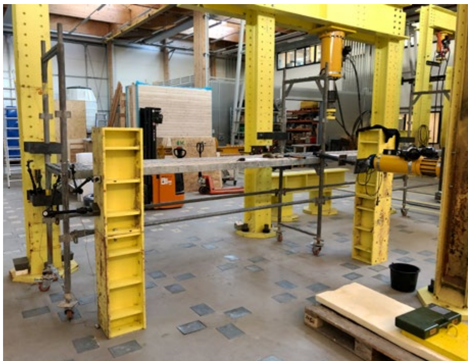
Obr. 1 Fotografie ze zkoušky tuhosti podlahy lešení kolmo k fasádě
